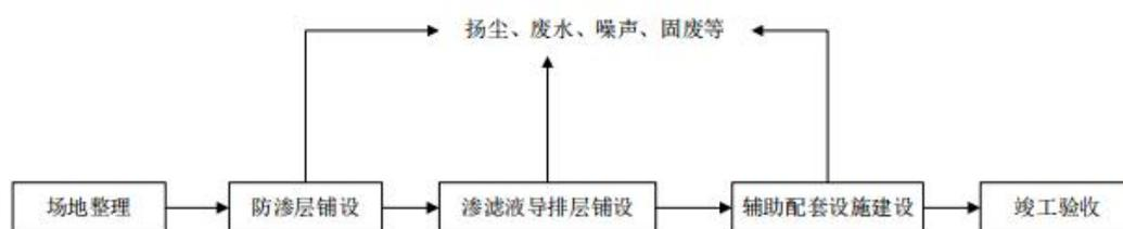
图 3.9-1 施工期工艺流程及产污环节示意图
